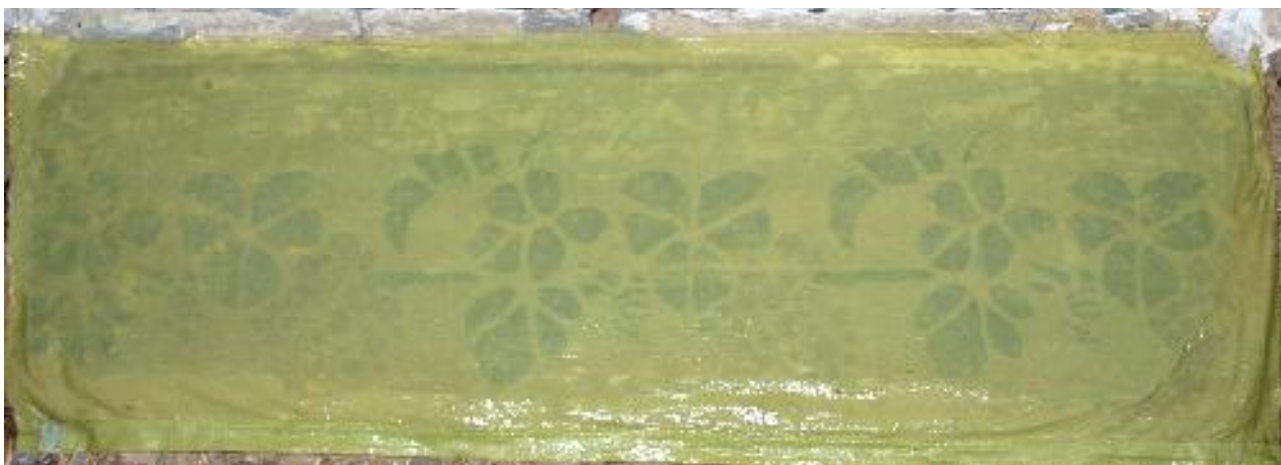
Sicherungsklebung mit Knochenleim für die Putzabnahme
